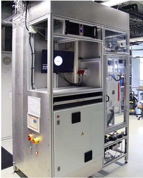
Abb. 1 Direktreduktionsanlage im Labormaßstab für reaktionskinetische Untersuchungen und Modellierung des Schachtofens
